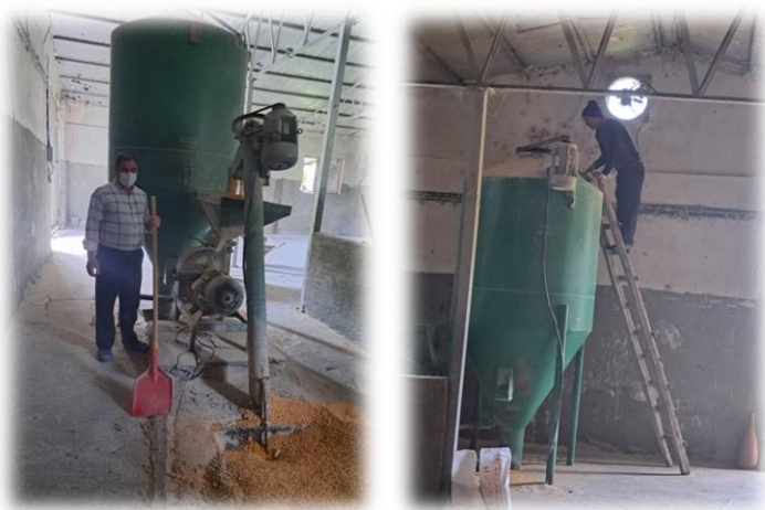
شکل ۶- دستگاه آسیاب، بالابر و مخلوط‌کن جیره مورد نیاز بوقلمون ایستگاه
